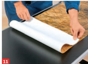
11 Schlagen Sie die zugeschnittene Bahn wie im Bild um und rollen sie dann ...
